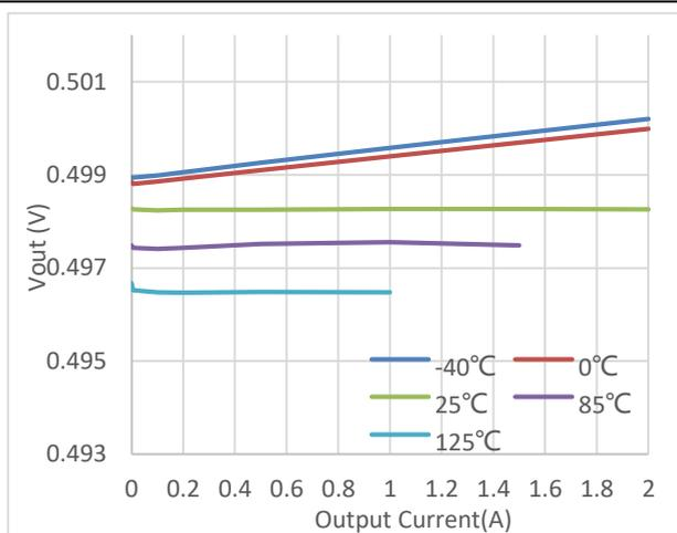
$V_{IN}=1.4\text{V}$ ,  $V_{OUT}=0.5\text{V}$ ,  $OUT=FB$
