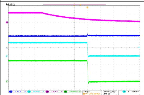
CH1= $V_{IN}$ , CH2= $V_{OUT}$ , CH3= $V_{EN}$ , CH4= $I_{OUT}$
