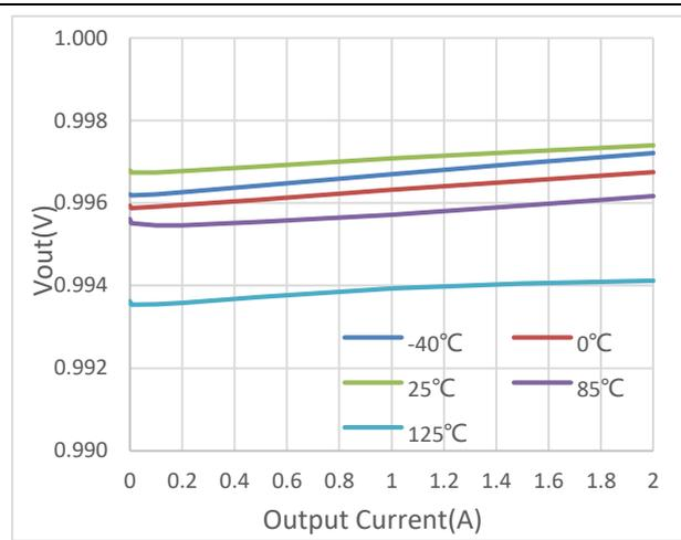
$V_{IN}=1.4\text{V}$ ,  $V_{OUT}=1.0\text{V}$
