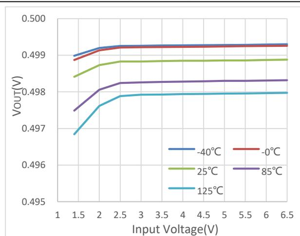
$V_{IN}=1.4\text{V}$ ,  $V_{OUT}=0.5\text{V}$ ,  $OUT=FB$
