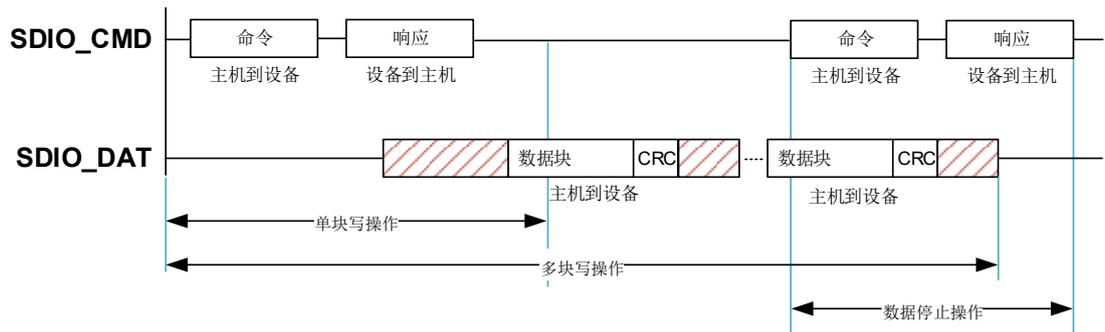
SD 存储卡、SD I/O 卡（包括仅 IO 卡和组合卡）和 CE-ATA 设备直接的数据传输是以数据块的方式完成的。MMC 卡以数据块或数据流方式进行数据传输。[图 20-4. SDIO 数据流读操作](#)和[图 20-5. SDIO 数据流写操作](#)分别是数据流的读和写操作。
