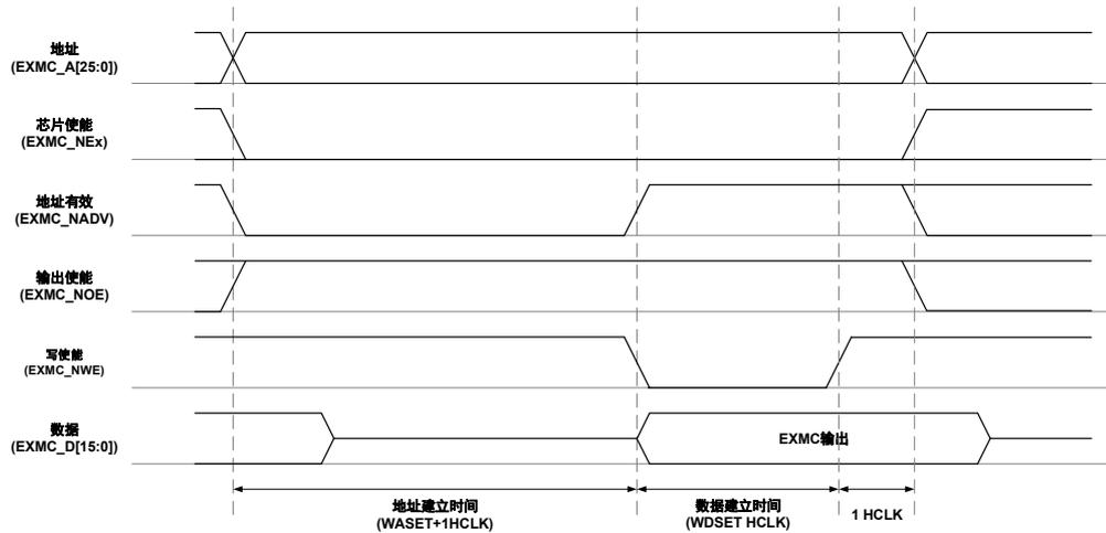
模式C和模式1的区别在于写时序，当两个模式的寄存器有相同的时序配置时，模式C的写时序独立于读时序。
