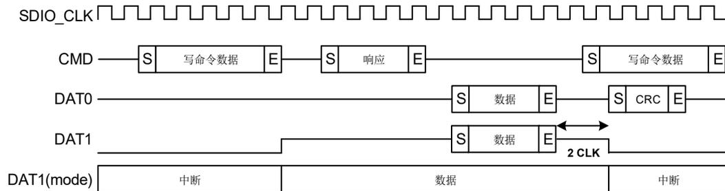
当在 4 位 SD 模式传送数据的多个块时，需要中断周期的特定的定义。为了运行通信的最高速度，中断周期限制在 2 个时钟周期。卡如果想向主机发送一个中断信号，应该在第一个时钟周期设置 DAT1 为低，第二个时钟周期设置 DAT1 为高。然后卡应释放 DAT1 进入 Hi-Z 状态。
