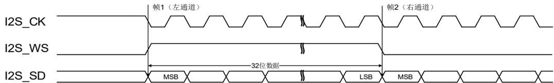
图 19-27. MSB 对齐标准时序图(DTLEN=01, CHLEN=1, CKPL=0)
