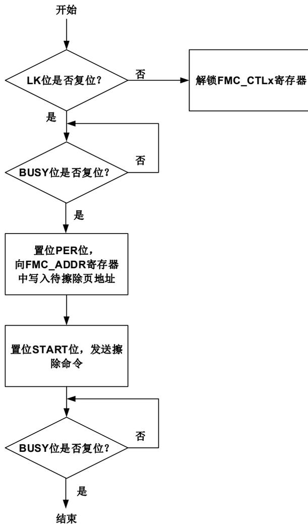
对于GD32F30x\_CL和GD32F30x\_XD, FMC\_STAT0寄存器反应对bank0和选项字节块的操作状态, FMC\_STAT1反应对bank1的操作状态。对bank1的页擦除操作与对bank0的页擦除操作类似。需要注意的是, 在安全保护状态下, 对bank1的页擦除, 需将地址同时写至FMC\_ADDR1和FMC\_ADDR0寄存器。
