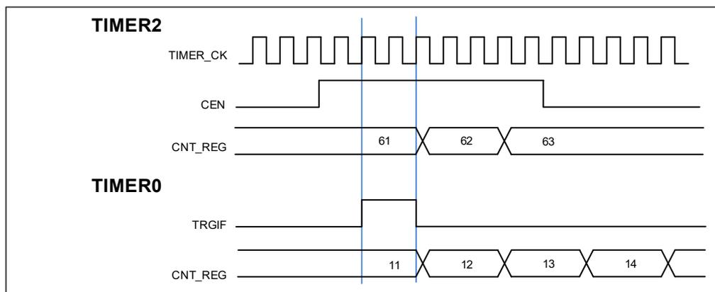
■ 使用一个外部触发来同步两个定时器
