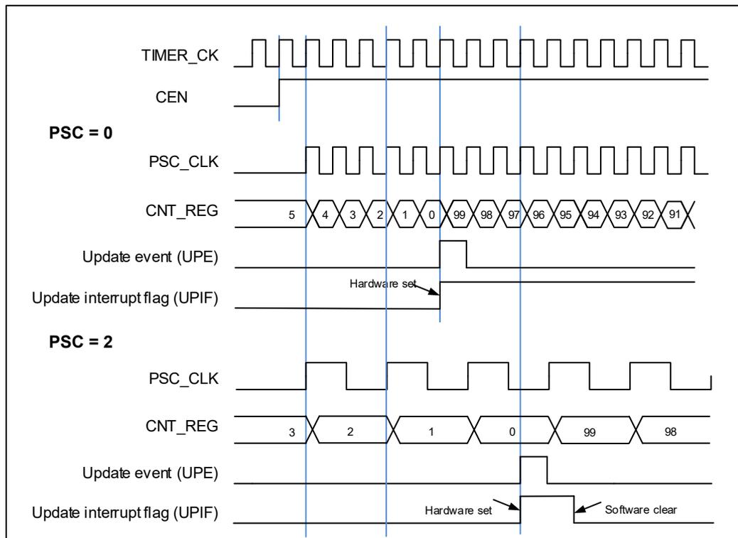
图 16-7. 向下计数时序图，在运行时改变 TIMERx\_CAR 寄存器值
