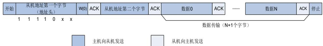
图 18-8. 10 位地址的 I2C 通讯流程（主机接收）
