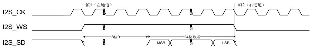
图 19-32. LSB 对齐标准时序图(DTLEN=01, CHLEN=1, CKPL=1)
