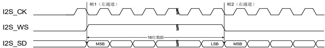
图 19-24. MSB 对齐标准时序图(DTLEN=00, CHLEN=0, CKPL=1)
