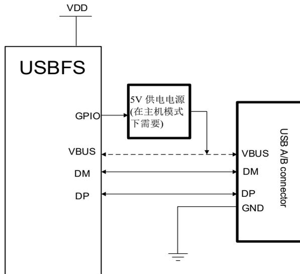
当USBFS工作在主机模式下时（FHM控制位置位、FDM控制位置清除），VBUS为USB协议所定义的5V电源检测引脚。内部PHY不能提供5V VBUS电源，仅在VBUS信号线上具有电压比较器和充电、放电电路。所以，如果应用需要提供VBUS电源，那么则需要一个外部的供电电源IC。在主机模式下，USBFS和USB连接头之间的VBUS连接可以被忽略，这是由于USBFS并不检测VBUS引脚的电平状态，并假定5V供电电源一直存在。
