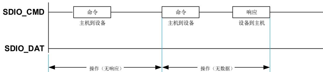
多块操作模式比单块操作速度更快。当 CMD 信号线上出现停止命令时，多块传输终止。主机数据传输可以使用单个或多个数据线。多个块的读操作如图 20-2. SDIO 多块读操作所示，多个块的写操作如图 20-3. SDIO 多块写操作所示。块的写操作在数据（DAT0）信号线上使用忙信号。CE-ATA 设备在准备接收数据之前有一个可选的忙信号。
