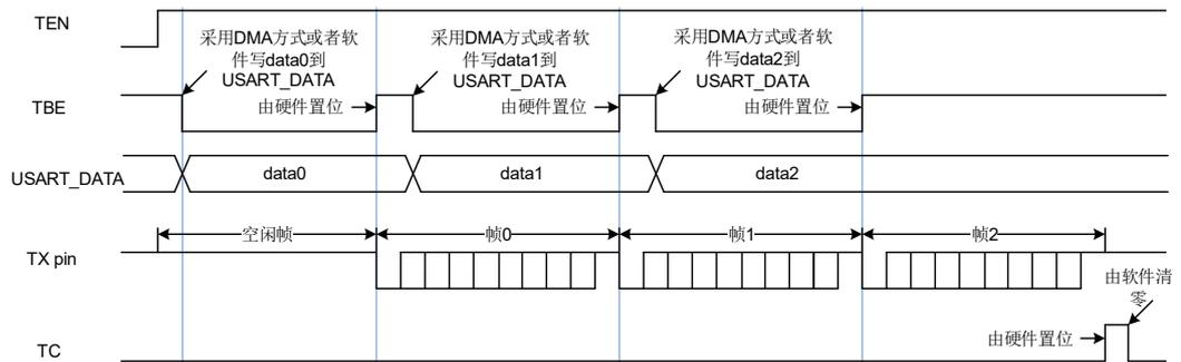
在禁用USART或进入低功耗状态之前，必须等待TC置位。先读USART\_STAT0然后再写USART\_DATA可将TC位清0。在多级缓存通信方式（DENT=1）下，直接向TC写0，也能清TC。
