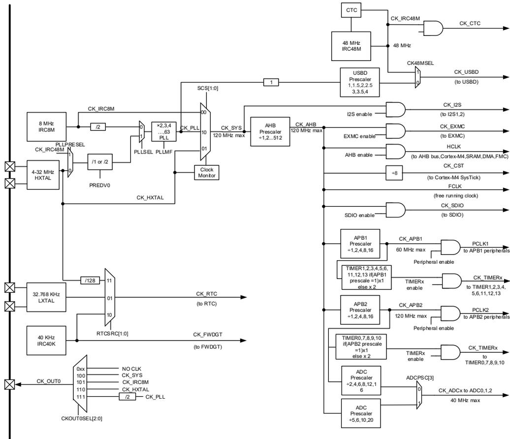
预分频器可以配置AHB、APB2和APB1域的时钟频率。AHB、APB2、APB1域的最高时钟频率分别为120MHz、120MHz、60MHz。RCU通过AHB时钟（HCLK）8分频后作为Cortex系统定时器（SysTick）的外部时钟。通过对SysTick控制和状态寄存器的设置，可选择上述时钟或AHB（HCLK）时钟作为SysTick时钟。
