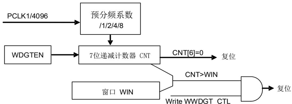
上电复位之后窗口看门狗定时器总是关闭的。软件可以向WWDGT\_CTL的WDGTEN写1开启窗口看门狗定时器。窗口看门狗定时器打开后，计数器始终递减计数，计数器配置的值应该大于0x3F，也就是说CNT[6]位应该被置1。CNT[5:0]决定了两次重装载之间的最大间隔时间。计数器的递减速度取决于APB1时钟和预分频器（WWDGT\_CFG寄存器的PSC[1:0]位）。
