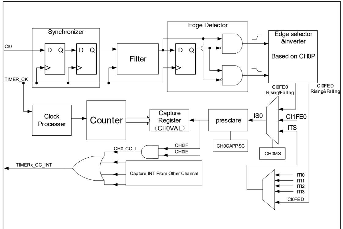
通道输入信号  $Cix$  有两种选择，一种是  $TIMERx\_CHx$  信号，另一种是  $TIMERx\_CH0, TIMERx\_CH1$  和  $TIMERx\_CH2$  异或之后的信号。通道输入信号  $Cix$  先被  $TIMER\_CK$  信号同步，然后经过数字滤波器采样，产生一个被滤波后的信号。通过边沿检测器，可以选择检测上升沿或者下降沿。通过配置  $CHxP$  选择使用上升沿或者下降沿。配置  $CHxMS.$ ，可以选择其他通道的输入信号，内部触发信号。配置  $IC$  预分频器，使得若干个输入事件后才产生一个有效的捕获事件。捕获事件发生， $CHxVAL$  存储计数器的值。
