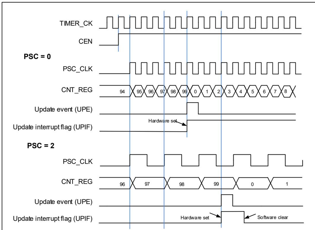
图 16-68. 向上计数时序图，在运行时改变 **TIMERx\_CAR** 寄存器的值
