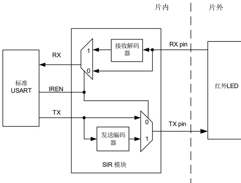
在IrDA模式下，TX引脚电平与RX引脚不同。TX引脚通常为低电平，RX引脚通常为高电平。IrDA引脚电平保持稳定代表逻辑‘1’，红外光源脉冲（RTZ信号）代表逻辑‘0’。其脉冲宽度通常占一个位时间的3/16。IrDA无法检测到宽度小于一个1个PSC时钟的脉冲。如果脉冲宽度大于1但是小于2倍PSC时钟，IrDA则无法可靠的检测到。
