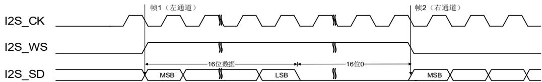
图 19-30. MSB 对齐标准时序图(DTLEN=00, CHLEN=1, CKPL=1)
