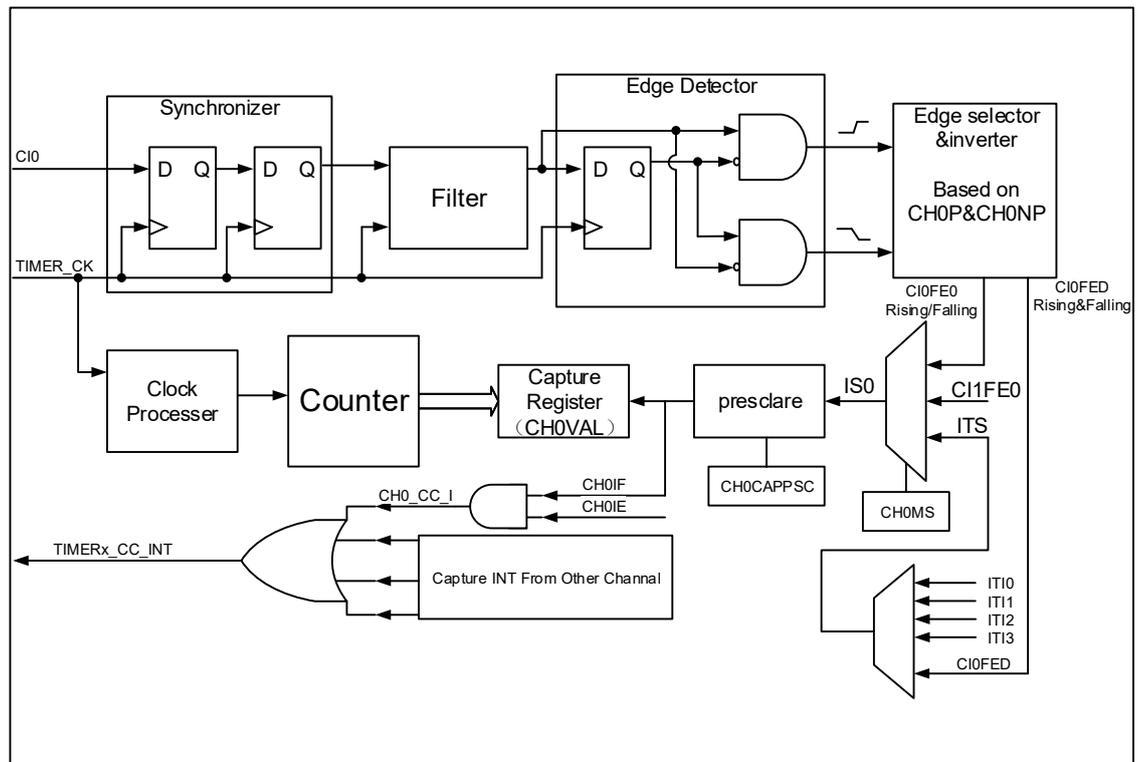
通道输入信号  $Ci_x$  先被  $TIMER\_CK$  信号同步，然后经过数字滤波器采样，产生一个被滤波后的信号。通过边沿检测器，可以选择检测上升沿或者下降沿。通过配置  $CHxP$  选择使用上升沿或者下降沿。配置  $CHxMS.$ ，可以选择其他通道的输入信号，内部触发信号。配置  $IC$  预分频器，使得若干个输入事件后才产生一个有效的捕获事件。捕获事件发生， $TIMERx\_CHxCV$  存储计数器的值。
