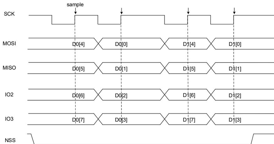
在常规模式中，通过 SPI\_CTL0 中的 FF16 位配置数据长度，当 FF16=1 时，数据长度为 16 位，否则为 8 位。在 SPI 四线模式下，数据帧长度固定为 8 位。
