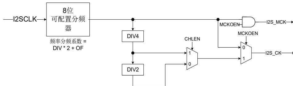
I2S 时钟生成器框图如 [图 19-51. I2S 时钟生成结构框图](#) 所示。I2S 接口时钟是通过 SPI\_I2SPSC 寄存器的 DIV 位, OF 位和 MCKOEN 位以及 SPI\_I2SCTL 寄存器的 CHLEN 位来配置的。I2S 比特率可以通过 [表 19-7. I2S 比特率计算公式](#) 所示的公式计算。
