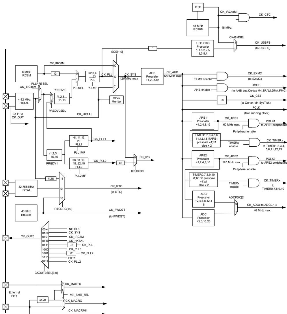
预分频器可以配置AHB、APB2和APB1域的时钟频率。AHB、APB2、APB1域的最高时钟频率分别为120MHz、120MHz、60MHz。RCU通过AHB时钟（HCLK）8分频后作为Cortex系统定时器（SysTick）的外部时钟。通过对SysTick控制和状态寄存器的设置，可选择上述时钟或AHB（HCLK）时钟作为SysTick时钟。
