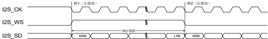
图 19-25. MSB 对齐标准时序图(DTLEN=10, CHLEN=1, CKPL=0)
