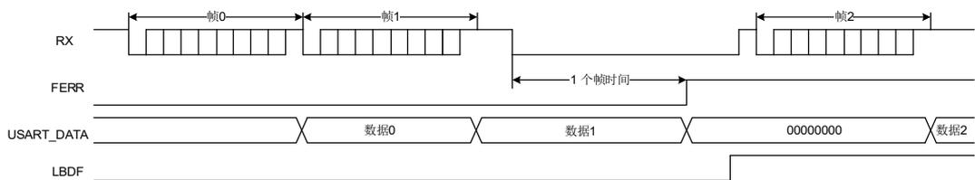
如[图17-10. 数据传输过程中检测断开帧](#)所示，如果断开帧发生在数据传输过程中，当前传输帧发生错误，FERR置位。
