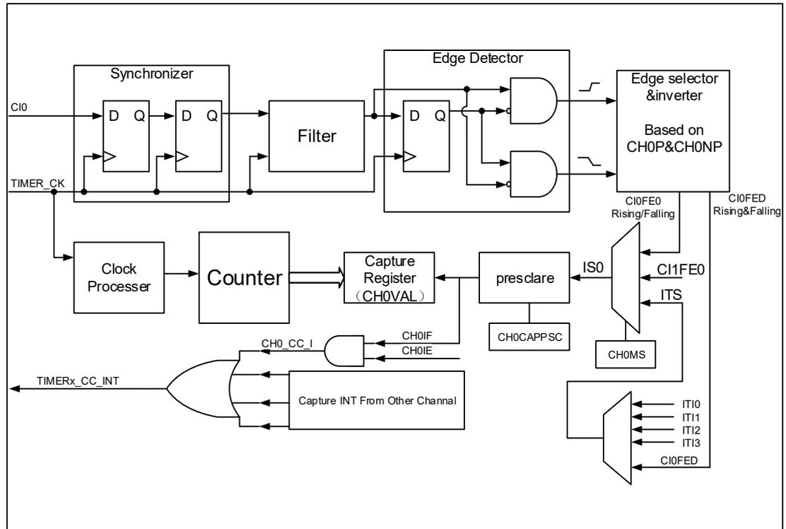
通道输入信号  $Cix$  有两种选择，一种是  $TIMERx\_CHx$  信号，另一种是  $TIMERx\_CH0, TIMERx\_CH1$  和  $TIMERx\_CH2$  异或之后的信号。通道输入信号  $Cix$  先被  $TIMER\_CK$  信号同步，然后经过数字滤波器采样，产生一个被滤波后的信号。通过边沿检测器，可以选择检测上升沿或者下降沿。通过配置  $CHxP$  选择使用上升沿或者下降沿。配置  $CHxMS.$ ，可以选择其他通道的输入信号，内部触发信号。配置  $IC$  预分频器，使得若干个输入事件后才产生一个有效的捕获事件。捕获事件发生， $TIMERx\_CHxCV$  存储计数器的值。
