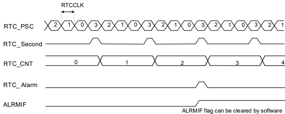
图 15-3. RTC 秒信号及溢出信号的波形(RTC\_PSC = 3)
