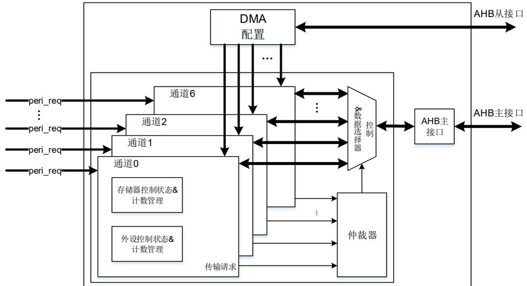
由图 10-1. DMA 结构框图所示，DMA 控制器由 4 部分组成：
