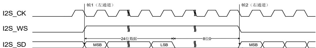
图 19-28. MSB 对齐标准时序图(DTLEN=01, CHLEN=1, CKPL=1)
