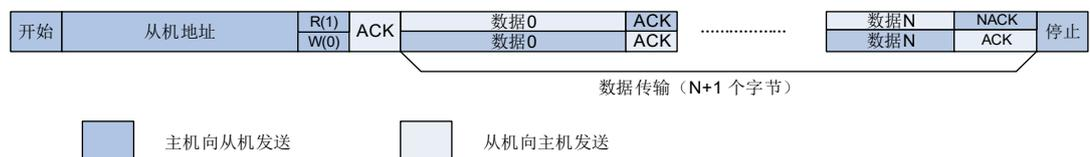
图 18-7. 10 位地址的 I2C 通讯流程（主机发送）
