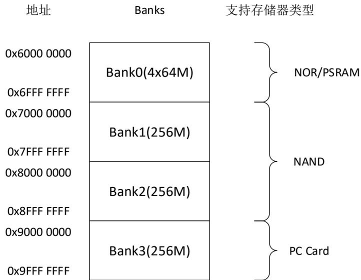
EXMC将外部存储器分成多个Bank，每个Bank占256M字节，其中Bank0又分为4个Region，每个Region占64M字节。Bank1和Bank2又都被分成2个Section，分别是属性存储空间和通用存储空间。Bank3分成3个Section，分别是属性存储空间，通用存储空间和I/O存储空间。
