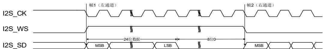
图 19-29. MSB 对齐标准时序图(DTLEN=00, CHLEN=1, CKPL=0)
