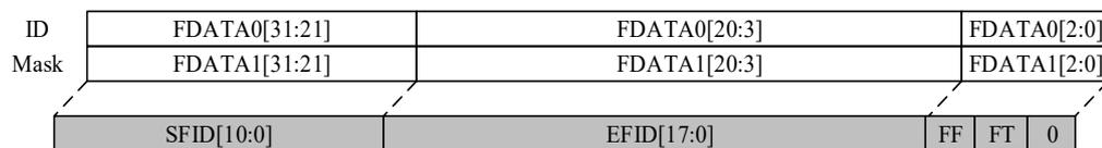
图 22-8. 16-bit 位宽掩码模式过滤器
