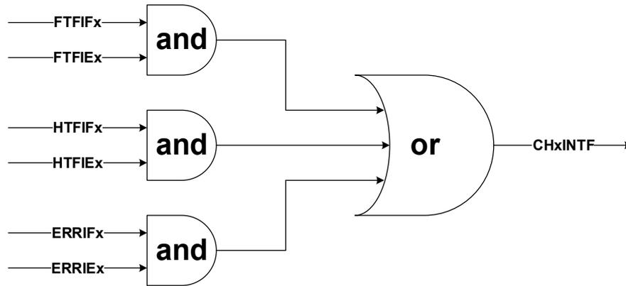
注意：“x”表示通道数（DMA0对应x=0...6；DMA1对应x=0...4）
