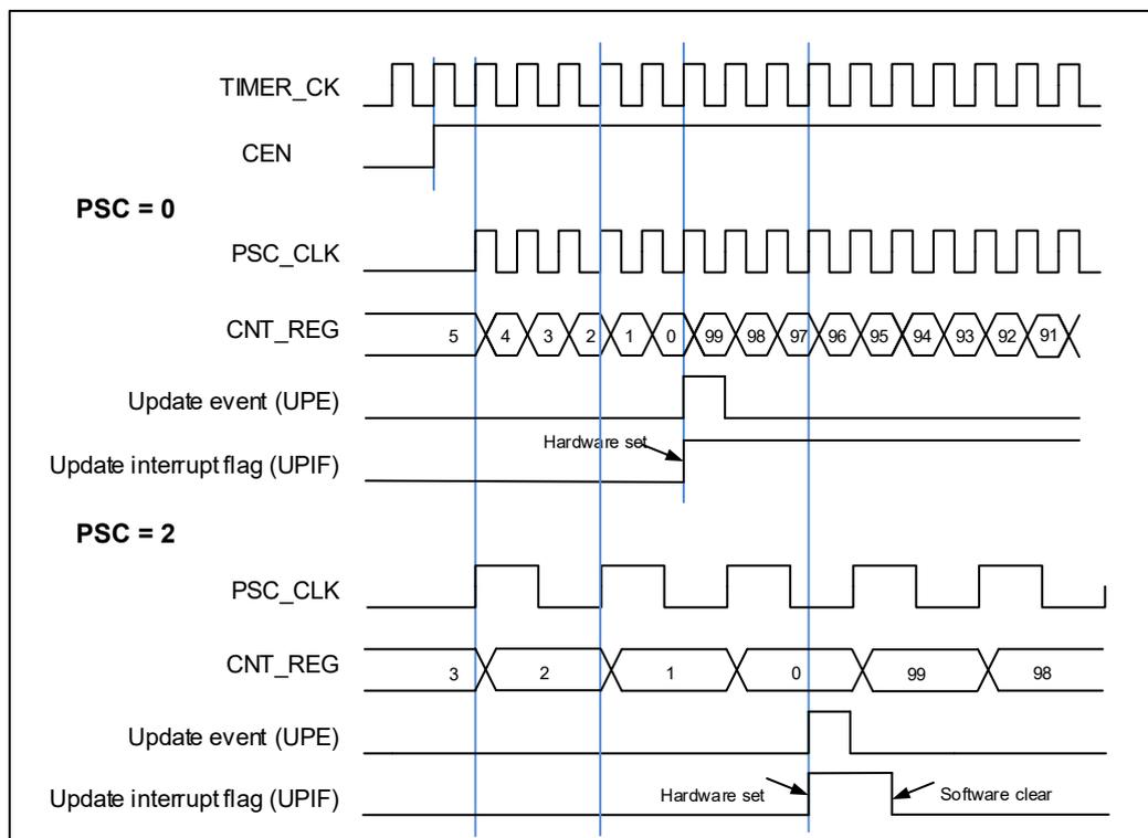
图 16-35. 向下计数时序图，在运行时改变 `TIMERx_CAR` 寄存器值
