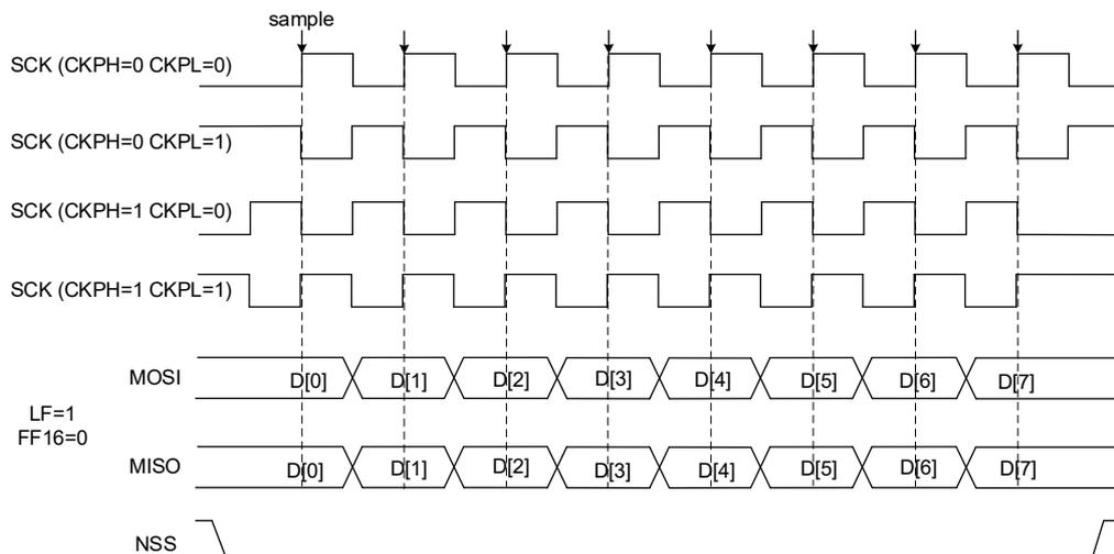
图 19-3. SPI 四线模式下的 SPI 时序图(CKPL=1, CKPH=1, LF=0)
