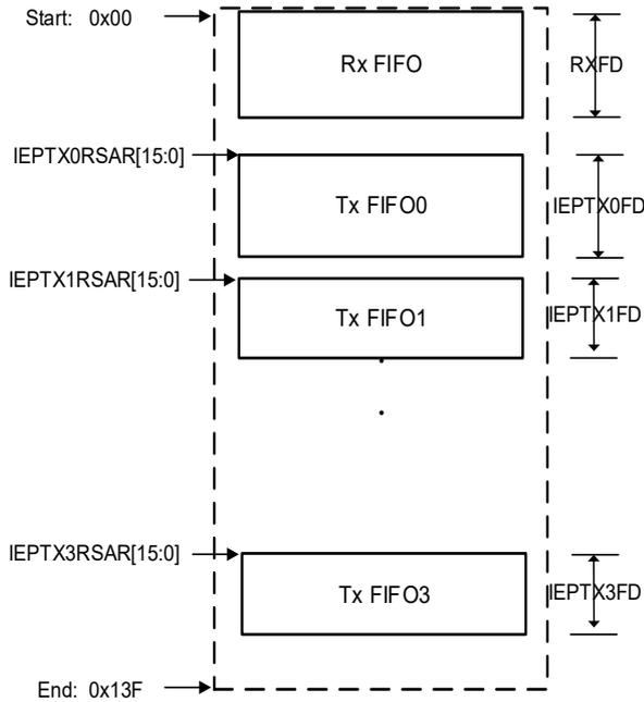
USBFS 为程序提供了专有寄存器空间来读写数据 FIFO。[图 25-8. 设备模式 FIFO 访问寄存器映射表](#)所描述的是数据 FIFO 所访问的寄存器存储空间，图中的数值是以字节为单位寻址。每个端点都拥有它们的 FIFO 访问寄存器空间。通过寄存器 USBFS\_GRXTATR/USBFS\_GRSTATP 来访问 Rx FIFO。
