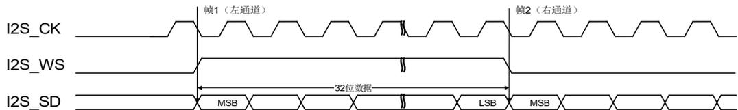
图 19-26. MSB 对齐标准时序图(DTLEN=10, CHLEN=1, CKPL=1)
