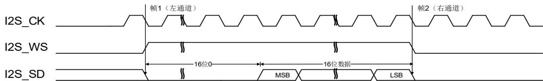
**图 19-34. LSB 对齐标准时序图(DTLEN=00, CHLEN=1, CKPL=1)**
