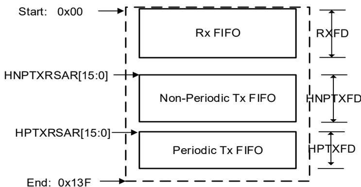
USBFS 为程序提供了专有寄存器空间来读写数据 FIFO。[图 25-6. 主机模式 FIFO 访问寄存器映射表](#)所描述的是数据 FIFO 所访问的寄存器存储空间，图中的数值是以字节为单位寻址。尽管所有的非周期通道共享相同的 FIFO 以及所有的周期通道共享相同的 FIFO，每个通道都拥有它们的 FIFO 访问寄存器空间。对 USBFS 而言，获知当前压入数据包的通道号是非常重要的，通过寄存器 USBFS\_GRXTATR/USBFS\_GRSTATP 来访问数据包所从属的 Rx FIFO。
