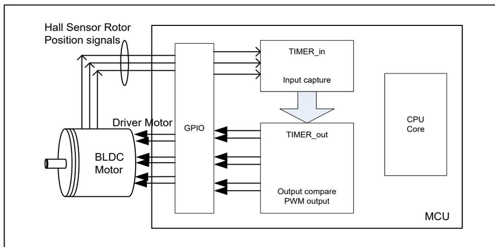
图 16-21. 两个定时器之间的霍尔传感器时序图
