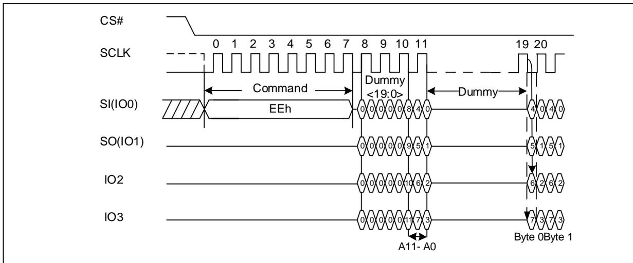
Figure 8-7.b Read From Cache Quad I/O DTR with DQS Sequence Diagram
